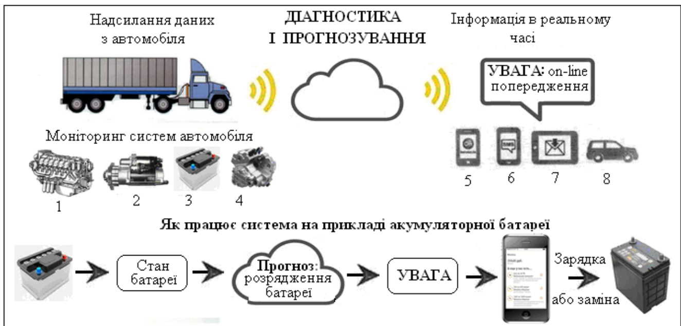
Рис. 7.10. Технологія Proactive Alerts для діагностування та прогнозування технічного стану:
