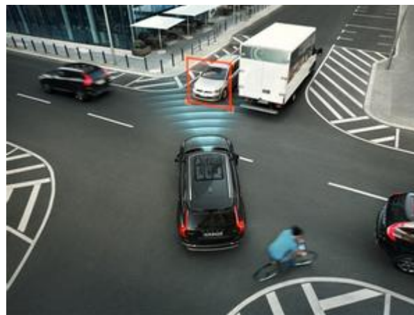
Рис. 6.11. Функція автоматичного гальмування перед зустрічним транспортом
