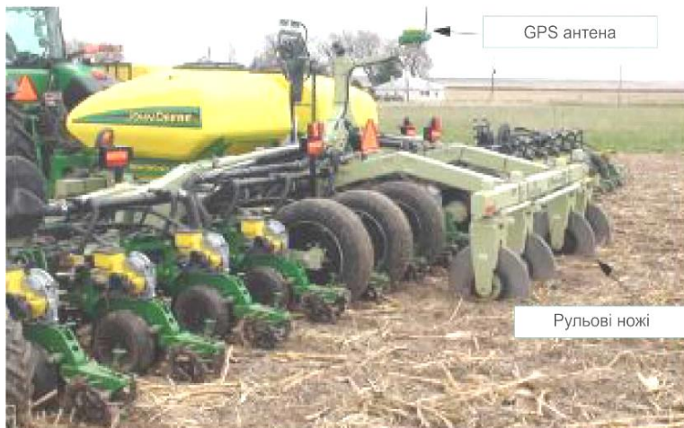
Рис. 12.11. Активне керування сівалкою на боковому схилі, GPS-антену на даху трактора не видно
