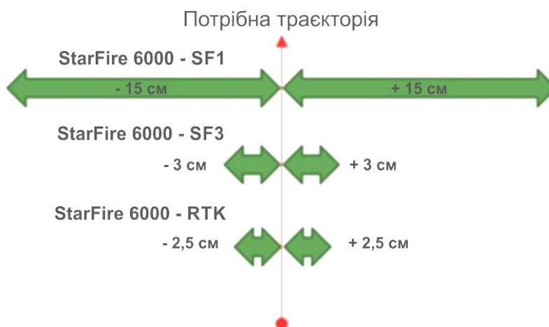
Рис. 11.9. Рівні точності сигналів SF1, SF3, RTK
