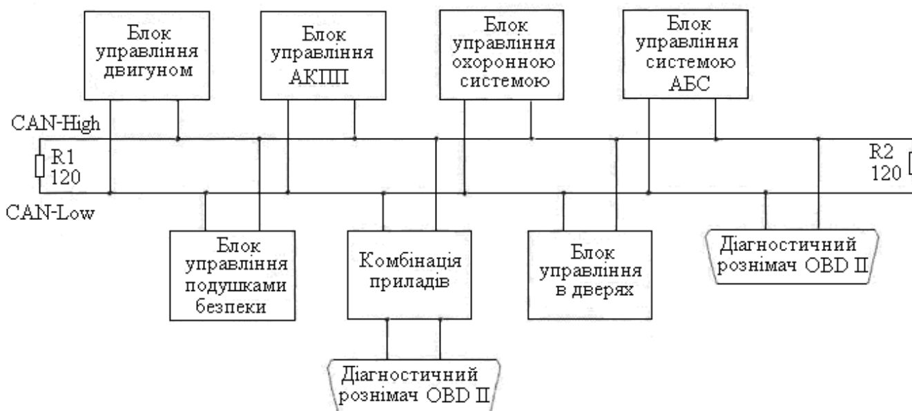
Рис. 4.5. Типова схема шини CAN
