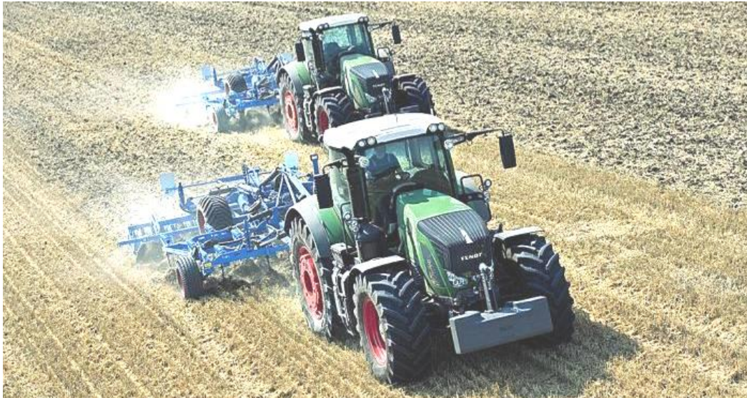
Рис. 12.9. Синхронізація роботи тракторів з допомогою системи Guide Connect
