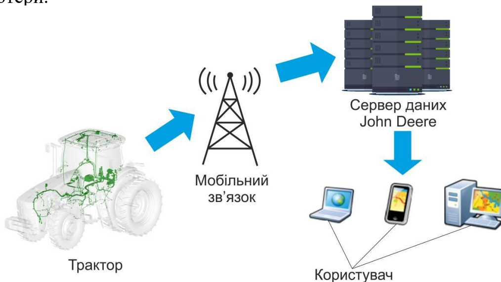
Рис. 15.2. Принципи роботи телематичної системи JDLink та операційного центру
