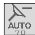
Рис. 13.7. Кнопки збільшення (а) та зменшення (б) чутливості рульового керування
