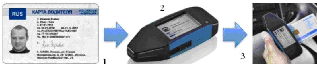
Рис. 8.17. Зчитування даних с карти с допомогою завантажувача:
