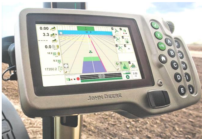
Рис. 11.2. Дисплей інтерфейсу користувача до автоматичної системи керування
