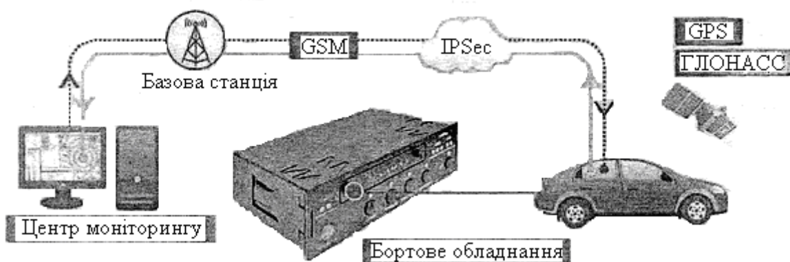
Рис. 6.8. Схема зв'язку бортового обладнання системи моніторингу стану водія
