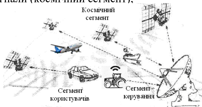
Рис. 1.2. Загальна схема структури супутникової навігаційної системи
