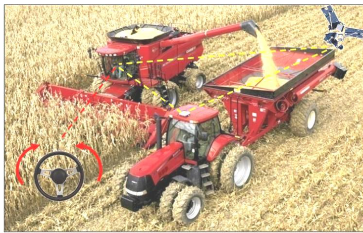
Рис. 12.8. Синхронізація роботи машин з допомогою системи V2V
