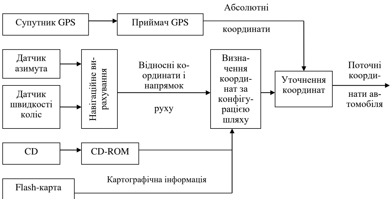
Рис. 1.7. Спрощена структура навігаційної системи
