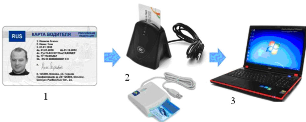
Рис. 8.16. Зчитування даних з карти з допомогою рідера:
