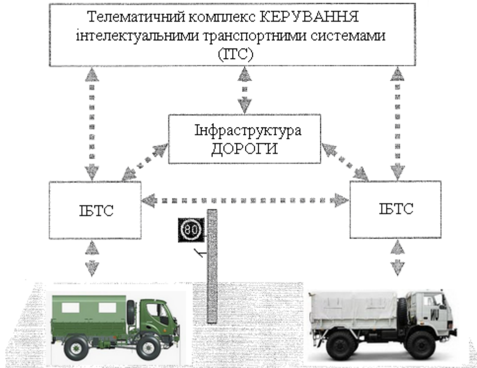
Рис. 5.9. Структурна схема телематичного комплексу керування ІТС
