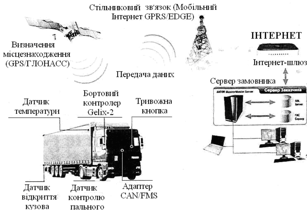
Рис. 3.3. Загальна структура трекінгових систем реального часу
