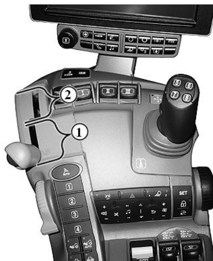
Рис. 13.2. Установлення функцій іТЕСТ: 1 – діапазон швидкостей 1; 2 – діапазон швидкостей 2
