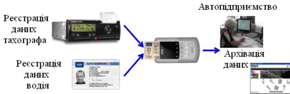
Рис. 8.13. Схема використання даних у системі транспортного моніторингу
