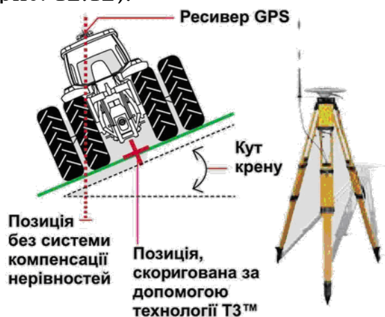
Рис. 12.10. Система автоматичного водіння AutoTrac з сигналом коригування RTK
