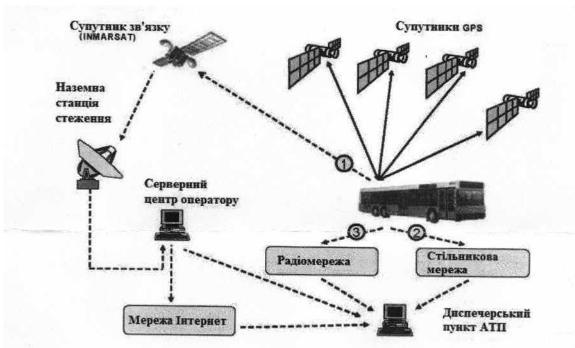
Рис. 1.9. Схема роботи диспетчерської навігаційної системи з варіантами передачі даних про місцезнаходження транспортного засобу
