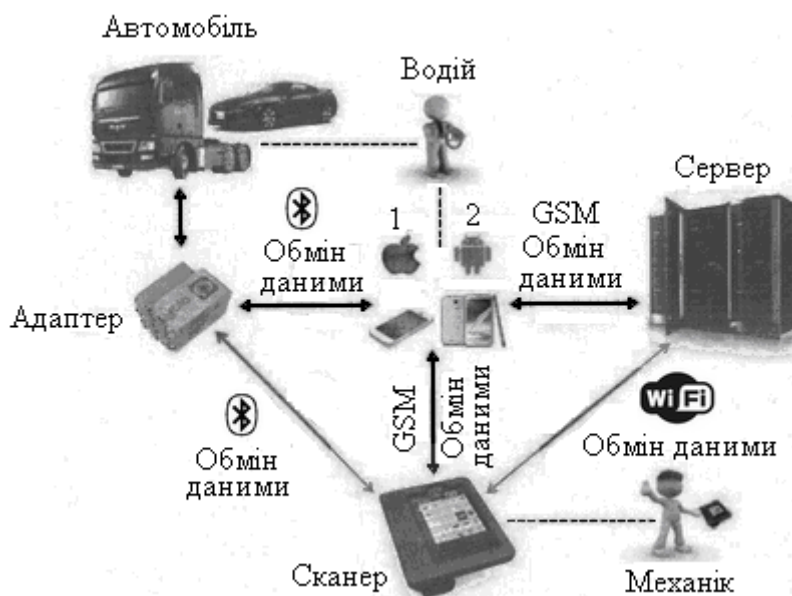
Рис. 7.8. Дистанційна комп'ютерна діагностика автомобіля:
