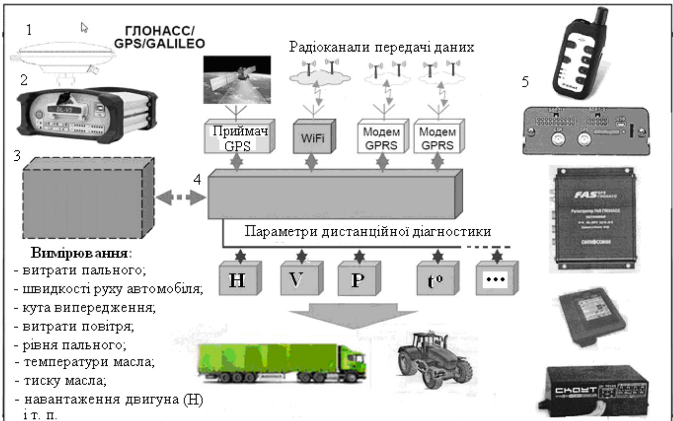
Рис. 7.9. Схема й обладнання системи дистанційної діагностики:
