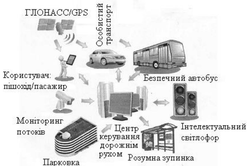
Рис. 3.7. Схема інформаційних потоків в інтелектуальних системах керування міським пасажирським транспортом
