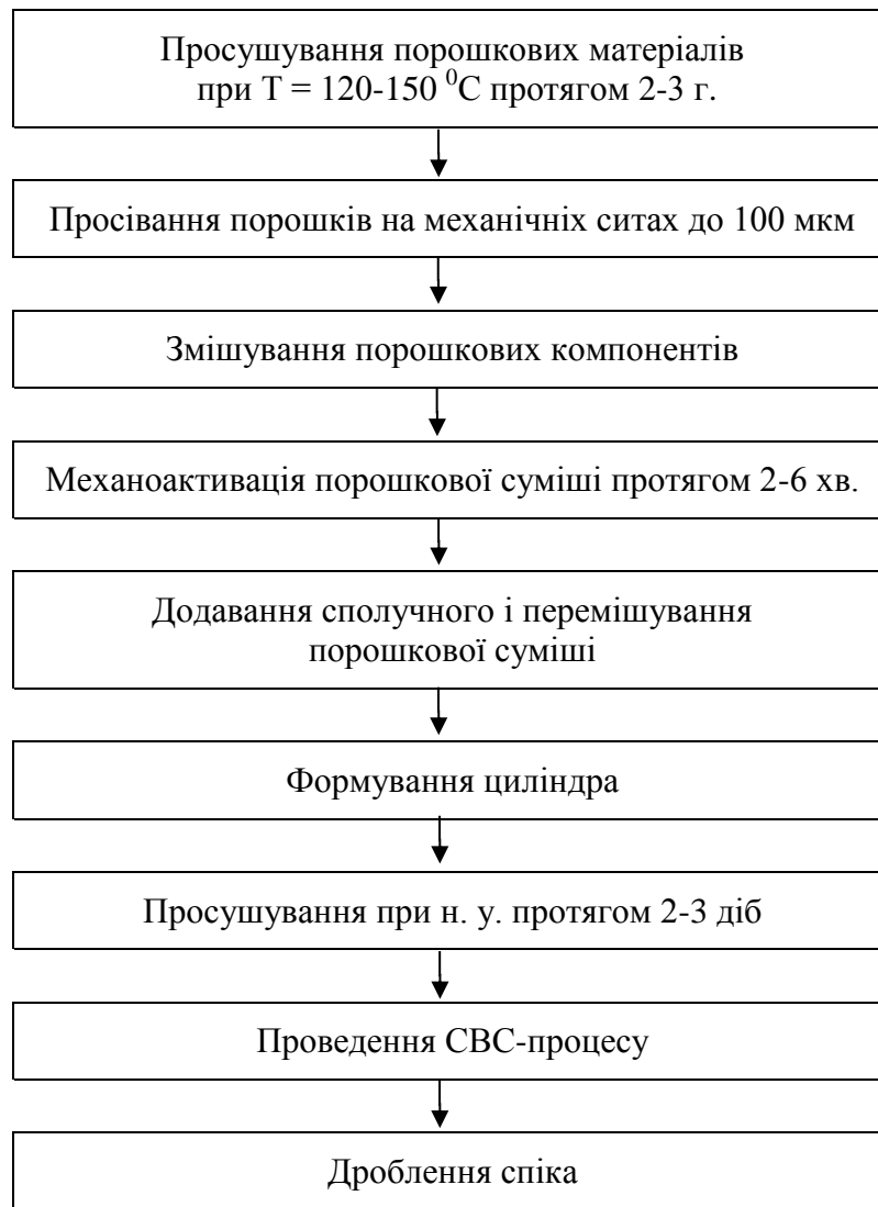
Рисунок 1 – Технологічні етапи виготовлення модифікуючого матеріалу
