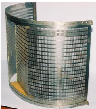
Рис. 6. Общий вид цилиндрического решета со ступенчатым продольным изгибом
