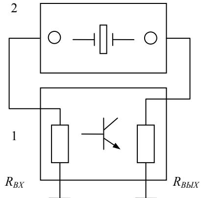
Рисунок 1 – Обобщенная структурная схема кварцевого генератора
