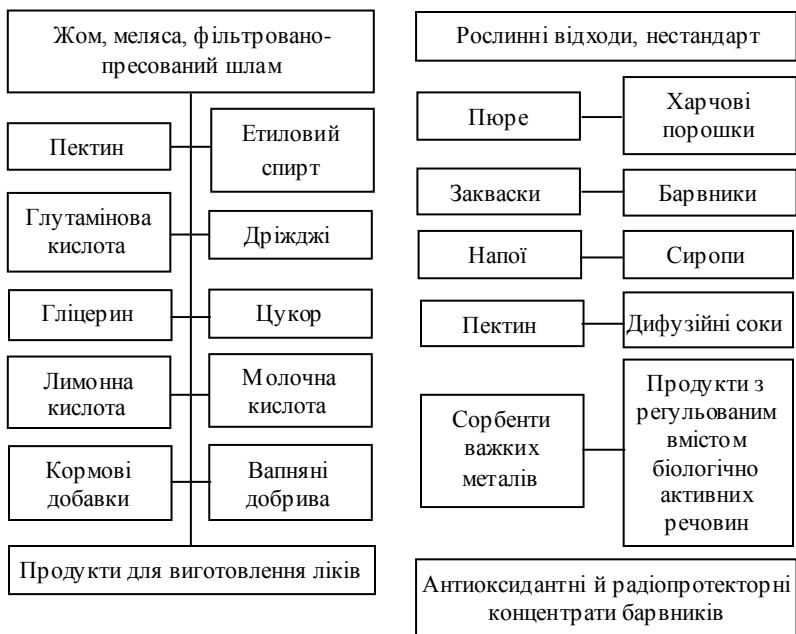
Рис. 1. Схема безвідходної технології переробки відходів виробництва основної плодово-ягідної продукції
