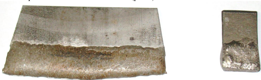
Рис. 1. Композиційний сплав типу стеліт, нанесений наплавленням в вакуумі на основу зі сталі 12X18H10T
