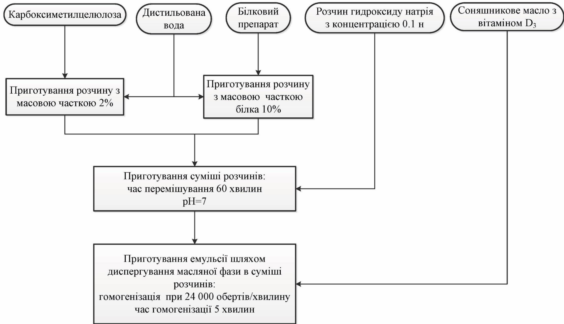
Рисунок 4.33 – Принципова технологічна схема виготовлення харчової емульсії масло-вода
