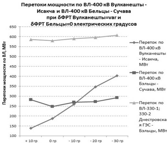
Рисунок 5 – Перетоки мощности по ВЛ-400 кВ Вулканешты – Исакача и ВЛ-400 кВ Бэльцы – Сучава при  $\delta$  ФРТ Вулканешты = var и  $\delta$  ФРТ Бэльцы = 0 электрических градусов
