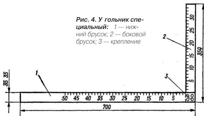
Рис. 4. Угольник специальный: 1 — нижний брусок; 2 — боковой брусок; 3 — крепление
