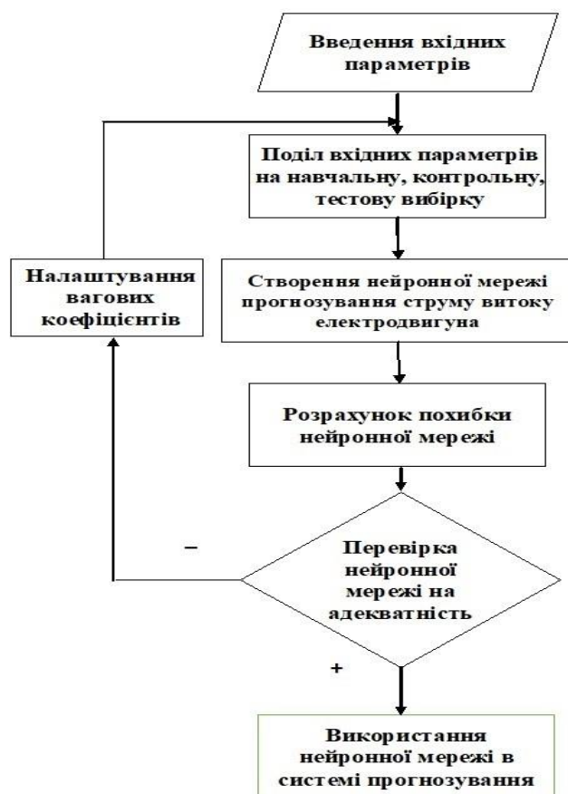
Рис. 1 – Алгоритм створення нейронної мережі для прогнозування струму витoku електродвигуна
