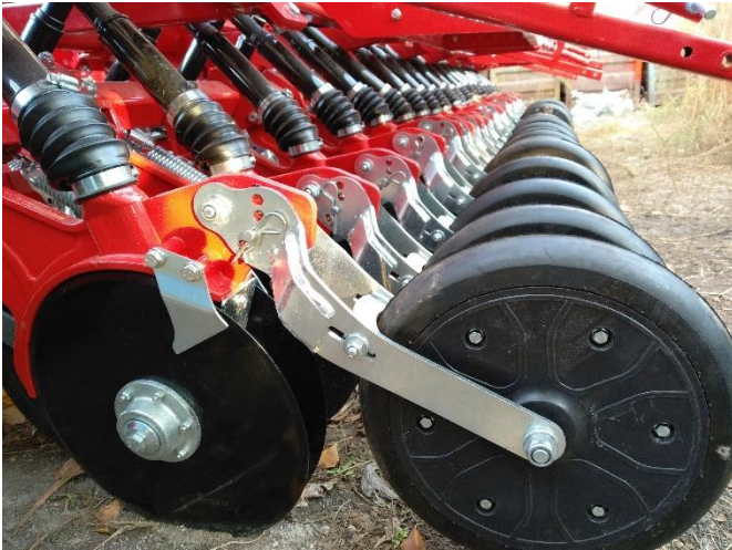
Рисунок 2 - Дводискові сошники сівалок AGM-HMT та AGM-HMTP
