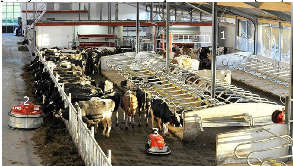
Рисунок 2 – Роботизовані системи тваринницького комплексу: 1 – доїльний робот; 2 – робот для підрівнювання кормів; 3 – робот для прибирання гною.
