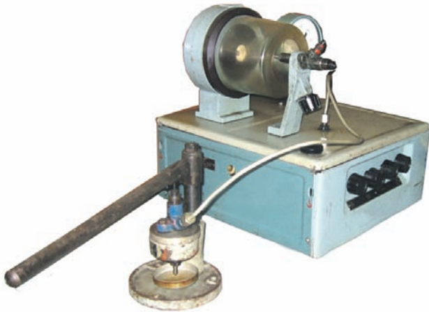
Рис. 1. Загальний вигляд установки для визначення діаметра запирання
