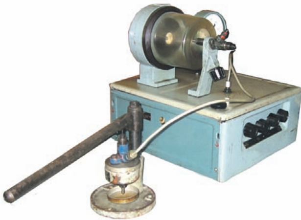
Рис. 1. Загальний вигляд установки для визначення діаметра запирання
