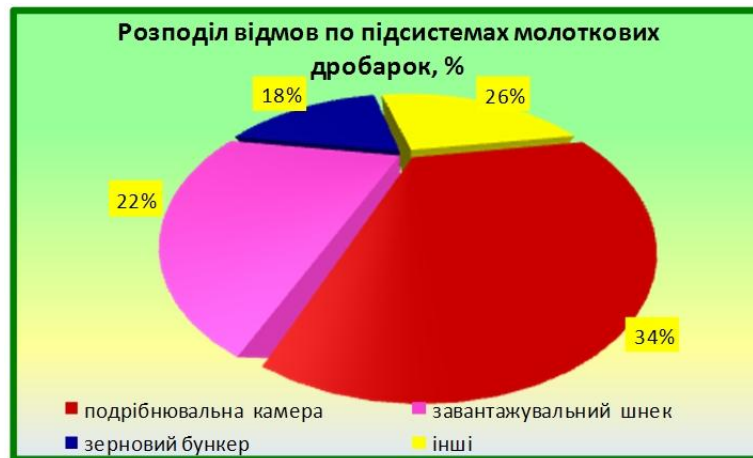
Рис. 1 - Розподіл відмов по підсистемах молоткових дробарок, %
