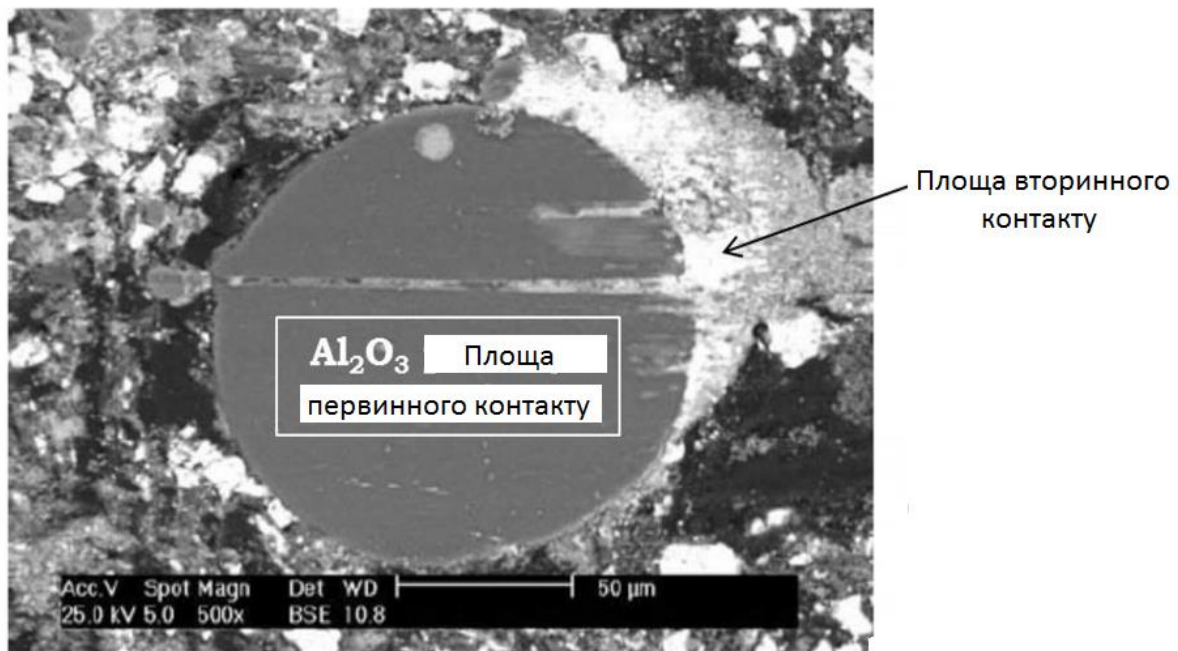
Рис. 2. Вигляд SEM вторинного контактної плати, складеної дрібними ущільненими частинками, утвореними плато первинного контакту глинозему.
