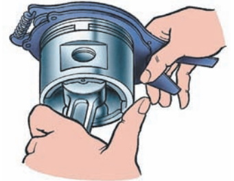
Рис. 3. Зняття і установка поршневих кілець
