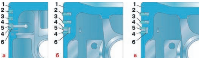
Рис. 1. Установка кілець на поршні: а – поршень з кільцями двигуна УМЗ-4178.10; б, в – поршень з кільцями двигуна УМЗ-4218.10; 1 – поршень; 2 – верхнє компресійне кільце; 3 – нижнє компресійне кільце; 4 – кільцеві диски; 5 – осьовий розширювач; 6 – радіальний розширювач
