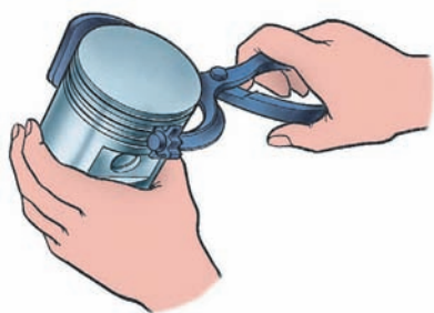
Рис. 5. Очищення канавок поршневого кільця від нагару
