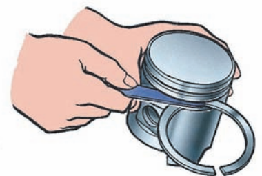
Рис. 4. Перевірка бічного зазору між поршневим кільцем і канавкою поршня
