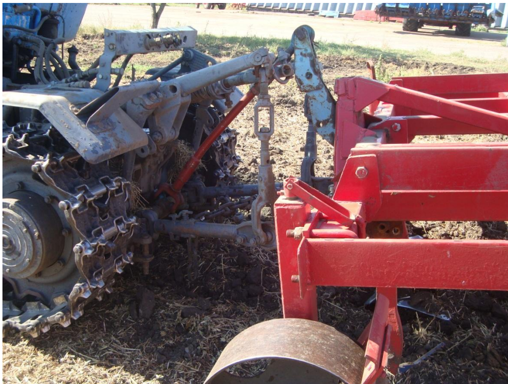
Рисунок 4 – Ґрунтообробний агрегат із експериментальною начіпною системою на базі трактора ХТЗ-200 і культиватора КЛД-3,0.
