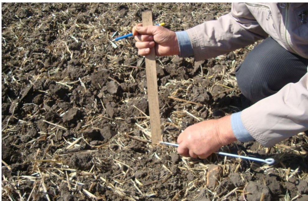
Рисунок 5 – Визначення глибини ходу культиватора КЛД-3,0 в складі ґрунтообробного агрегату на базі трактора ХТЗ-200.
