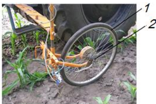
Рис. 4 – Засоби контролю поступальної швидкості дослідної установки з ротаційними робочими органами:
