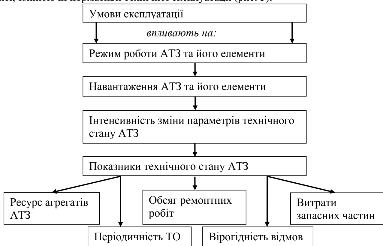
Рисунок 3 – Вплив умов експлуатації на інтенсивне зношування основних частин АТЗ
