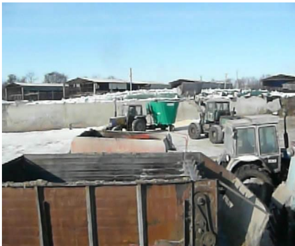
Рисунок 1 – Один навантажувач обслуговує три кормороздавача (ДП ДГ "Кутузівка"), і при цьому можливе завантаження "на потоці"
