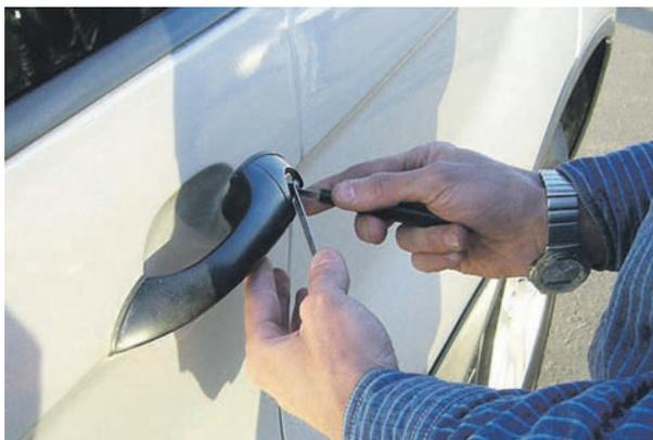
**ДВЕРЬ СЧИТАЕТСЯ ОТРЕГУЛИРОВАННОЙ ПРАВИЛЬНО, ЕСЛИ НЕ ВОЗНИКАЕТ ГРОМКОГО ЗВУКА И НЕ ТРЕБУЕТСЯ ПРИЛАГАТЬ БОЛЬШОЕ УСИЛИЕ ДЛЯ ЗАКРЫТИЯ ЗАМКА.**
