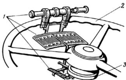
Рис. 1. Определение свободного хода рулевого колеса трактора: 1 - прибор К-402; 2 - рулевое колесо; 3 - рулевая колонка.
