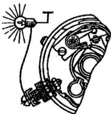
Рис. 4. Проверка цепи подвижного контакта распределителя зажигания.
