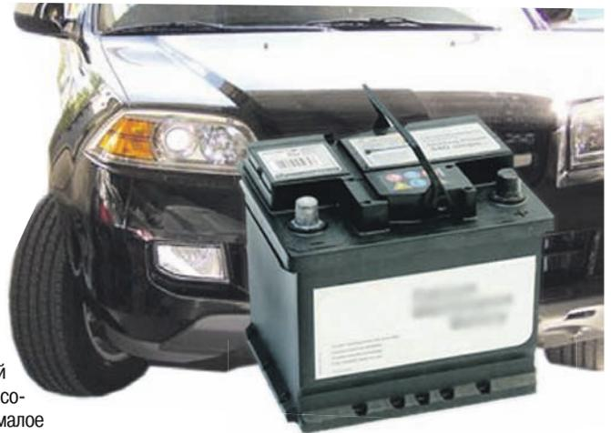
Допускается кратковременная вибрационная нагрузка 5g (ускорение 49 м/с<sup>2</sup>) с ориентировочной частотой до 30 Гц.
