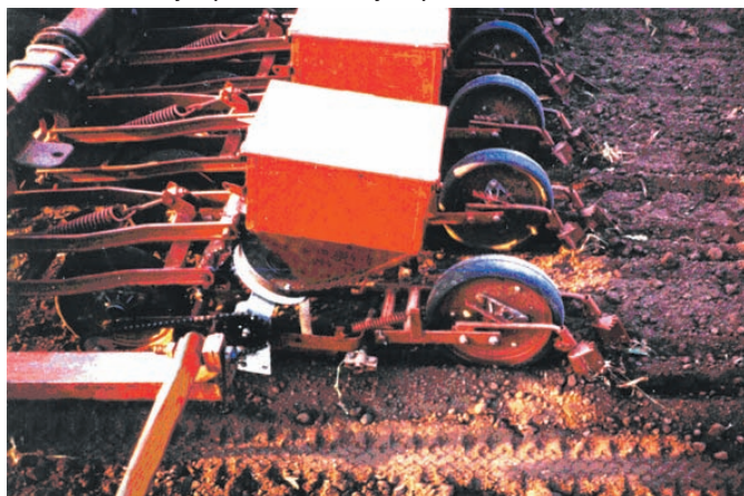
Рис. 2. Загальний вид експериментальної сівалки з вібраційно-дисковими висівними апаратами для висіву широкорядним способом дрібного насіння малими нормами.
