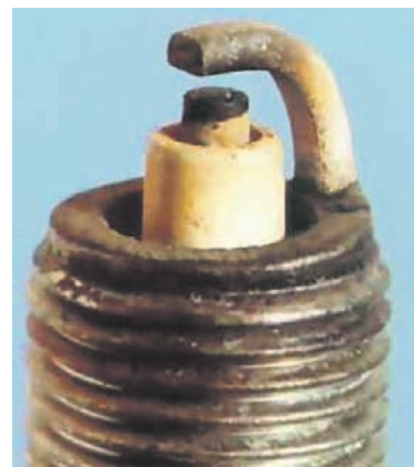
Рис 1. Свет ло-коричневый нагар. Нормальная работа свечи.
