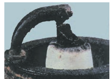
Рис 6. оплавление центра льного электрода
