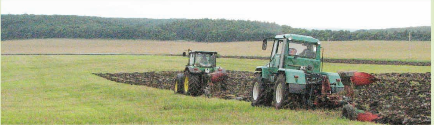
Трактори John Deere 7830 і "Слобожанець" ХТА-200 з 5-ти корпусними оборотними плугами ПО-5, (ЗАТ "ІНТЕРАГРОТЕК", Україна)
