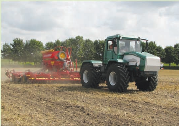
Трактор "Слобожанець" ХТА-200 з пневматичною сівалкою "Rapid" RDA 600C (Vaderstad, Швеція)
