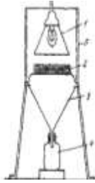
Рис. 1. Прилад Берлезе–Туллгрена: 1 – лампа розжарювання; 2 – сито; 3 – конічна воронка; 4 – збиральна посудина; 5 – бокові стінки штативи
