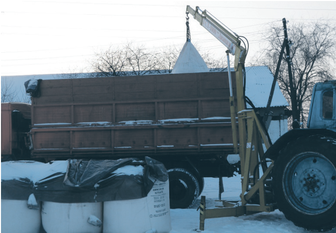
3. ГСТ опускает мешок «Биг – Бег» в кузов. Трактор с ГСТ установлен к автомобилю под углом 45 град.
