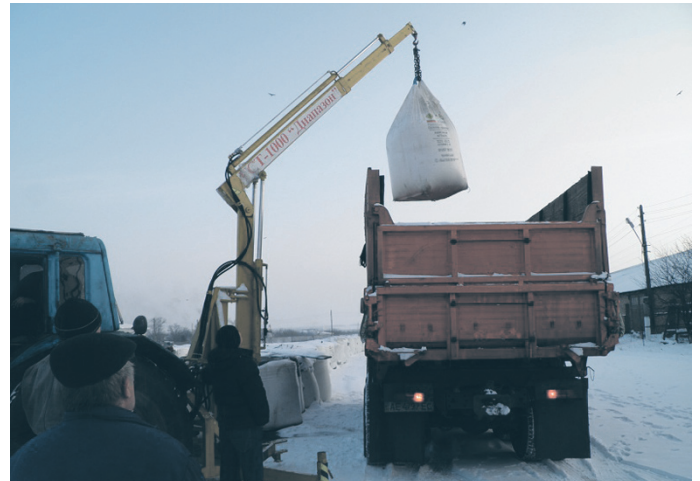
4. Обратный процесс – разгрузка, поднятие мешка стрелой происходит путем выдвигания «телескопа».
