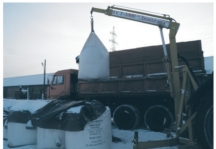
6. «Телескоп» складывается, и стрела опускает груз на место хранения.
