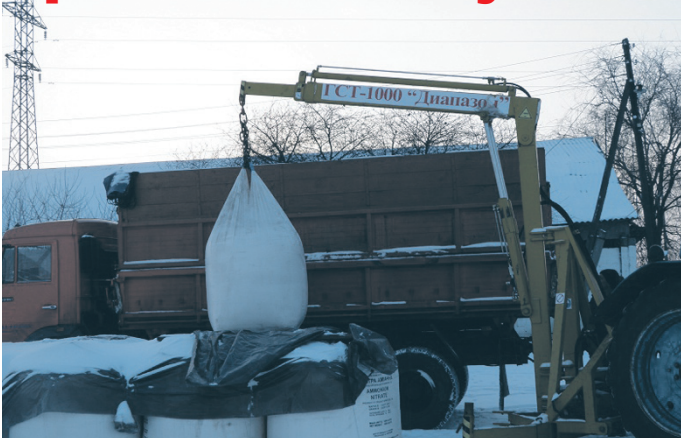
1. Погрузка аммиачной селитры в мешках «Биг – Бег» весом 1 т. Процесс подъема выполняется при сложенной стреле.
