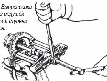
Рис. 13. Снятие переднего гнезда внутреннего вала, замена шлицевой втулки.
