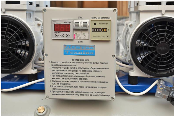
Рисунок 15.6 – Застереження щодо умов експлуатації компресора
