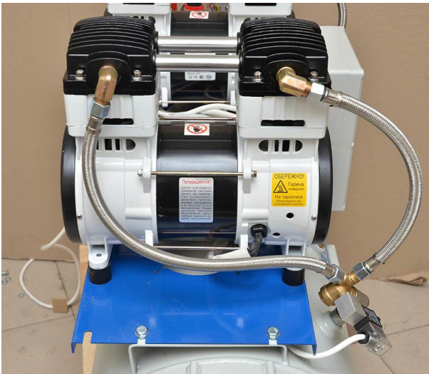
Рисунок 15.7 – Голівка стоматологічного компресора
