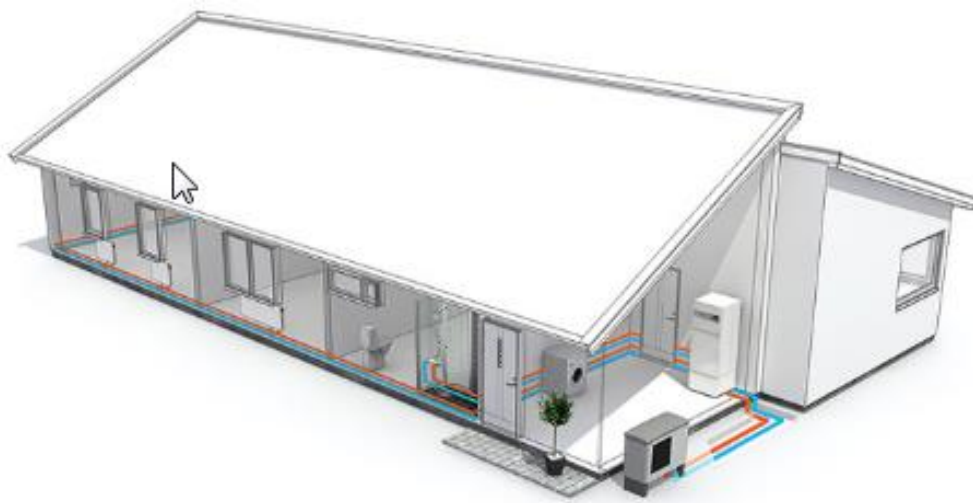
Рисунок 7.7 – Повітряний тепловий насос
