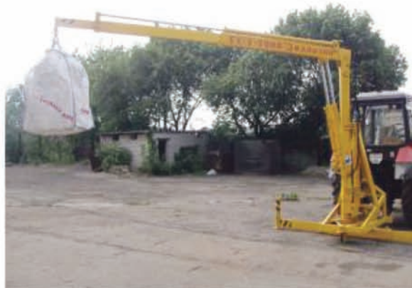
Максимальный вылет стрелы - 5,5 метра (мешок «Биг-Бег»(1 000 кг)
