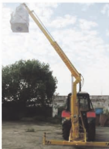
Максимальная высота подъема груза – 6,5 метра (мешок «Биг-Бег» (1000 кг)
