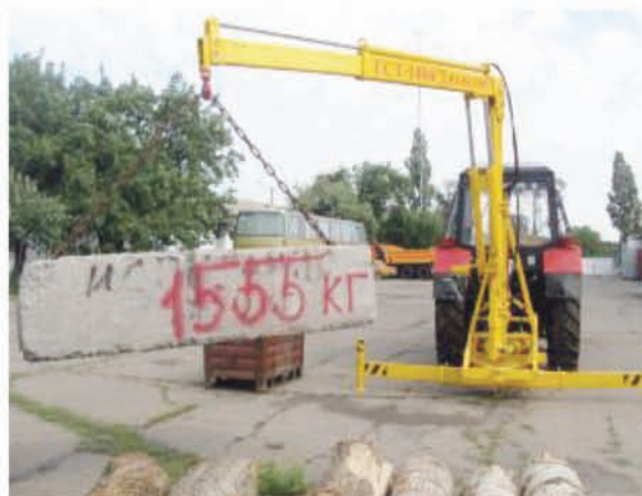
Сертификационные испытания контрольным грузом - 1555 кг
