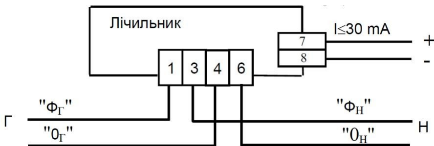
Рисунок 2.3 – Схема прямого вмикання лічильника СЕ102
