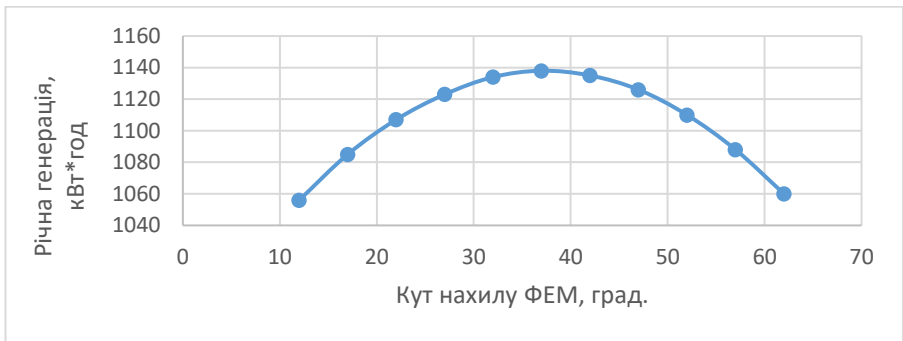
Рисунок 5 – Графік річної генерації СЕС в залежності від кута нахилу поверхні ФЕМ
