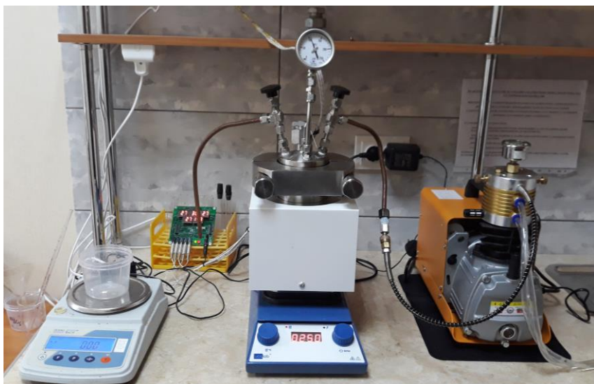
Рис. 1. Лабораторна установки для отримання екстрактів в середовищі субкритичної води
