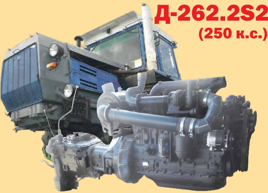
У результаті типових випробувань тракторів ХТЗ-17221 та ХТА-200, оснащених двигуном Д-260.4, встановлено, що двигун за конструкційними параметрами задовільно з'єднується з трансмісією трактора.
