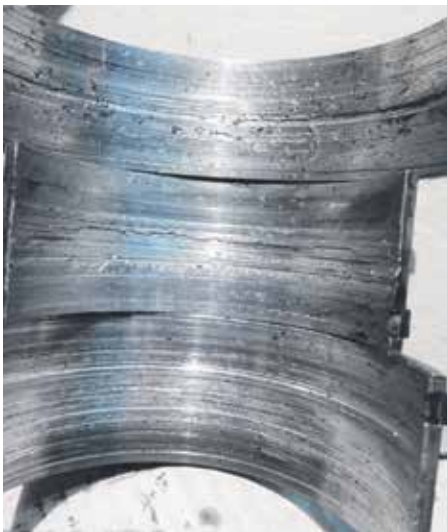
Рис. 1. Напливи на опірній шийці розподільного валу
