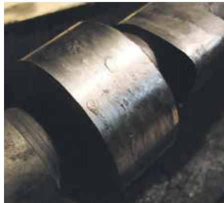
Рис. 1. Напливи на опірній шийці розподільного валу
