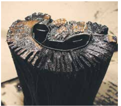
Рис. 5. Деформований фільтрувальний елемент із зірваним бандажем. Добре видно сліди неякісного приклеювання
