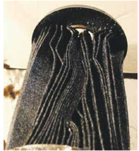
Рис. 4. Деформований і порваний фільтр
