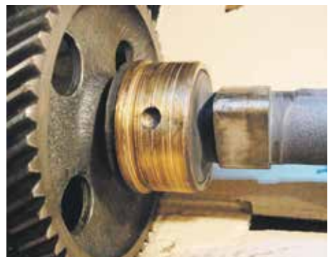
Рис. 3. Провертання втулки розподільного валу в блоці циліндрів
