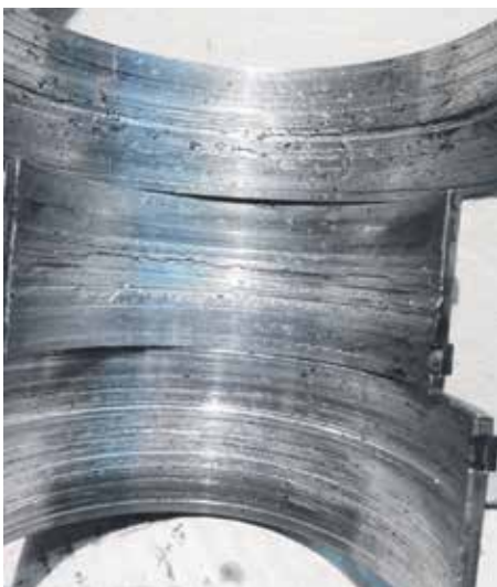
Рис. 5. Деформований фільтрувальний елемент із зірваним бандажем. Добре видно сліди неякісного приклеювання
