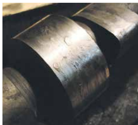
Рис. 1. Напливи на опірній шийці розподільного валу
