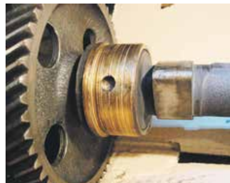
Рис. 3. Провертання втулки розподільного валу в блоці циліндрів
