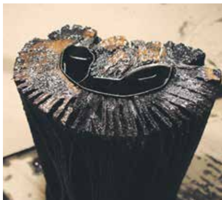
Рис. 5. Деформований фільтрувальний елемент із зірваним бандажем. Добре видно сліди неякісного приклеювання
