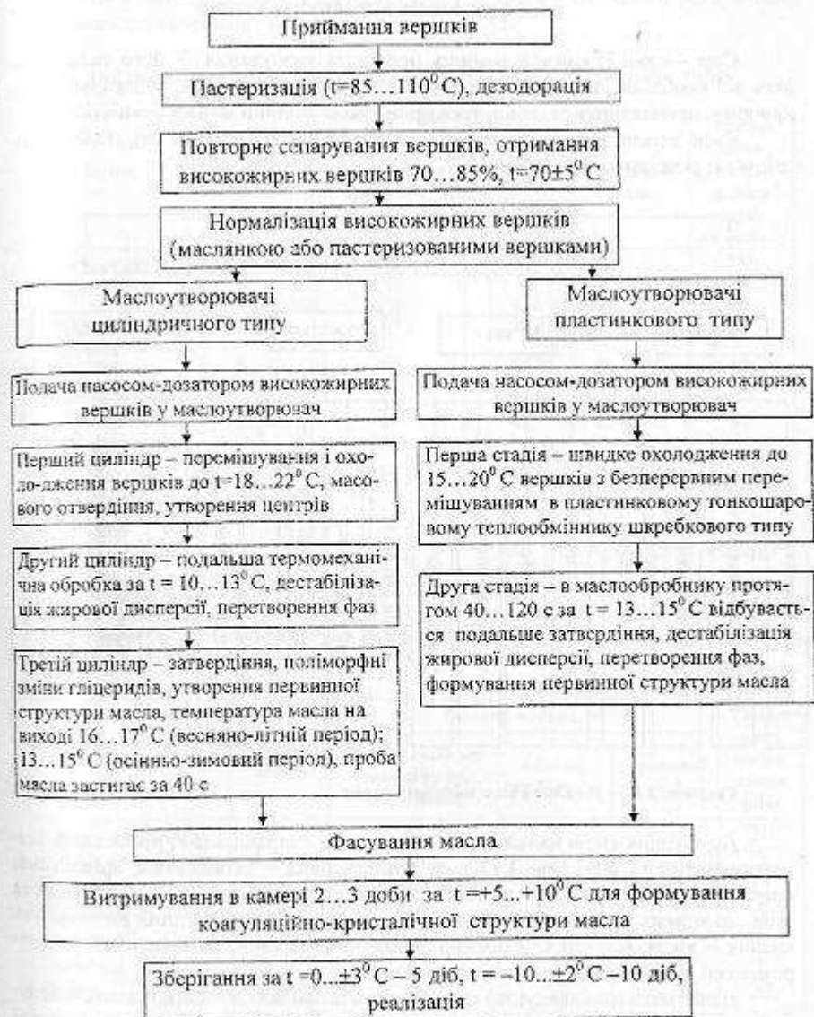
Рисунок 3.16 – Функціонально-технологічна схема виробництва масла методом перетворення високожирних вершків
