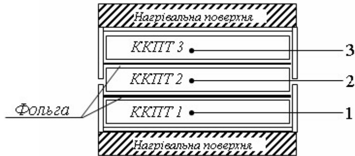
Рис. 3.13. Схема розміщення термопар та листів алюмінієвої фольги між шарами ККПТ під час моделювання ІнТМО за горизонтальної орієнтації сировини з газонепроникними включеннями (1, 2, 3 – термопари у відповідних шарах ККПТ)
