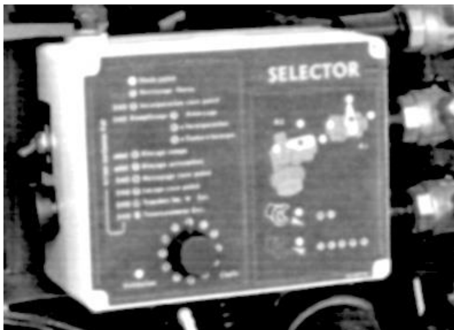
Рис. 49. Пульт діагностики і баки змішувачів причіпного обприскувача Olympia 320 S (ВОМ для насоса ГС) і самохідного Nimpheos 3240 від Caruelle-Nicolas
