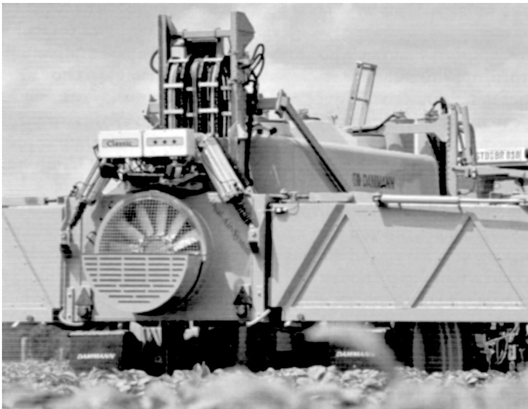
Рис. 52. Зовнішній вигляд Dual-Air-системи і його вентилятора на штангах обприскувачів Dammann «Подвійний удар» за один прохід
