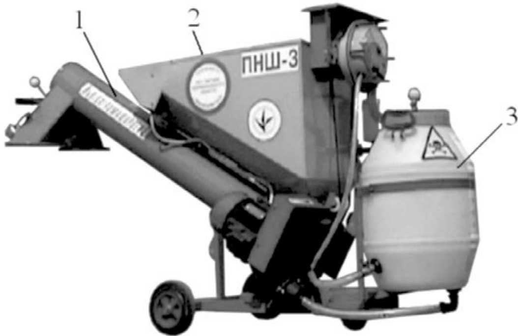
Рис. 22. Протруювач ПНШ-3 «Фермер»: 1 – шнек; 2 – бункер; 3 – бак
