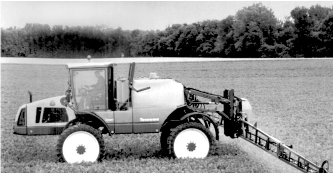
Рис. 35. Самохідний обприскувач LASER Об'єм бака 3200/4200/5200 л.+5 % Ширина захвату штанг 24, 28, 30, 32, 36 м Кліренс 1,1; 1,4; 1,6; 1,8 м
