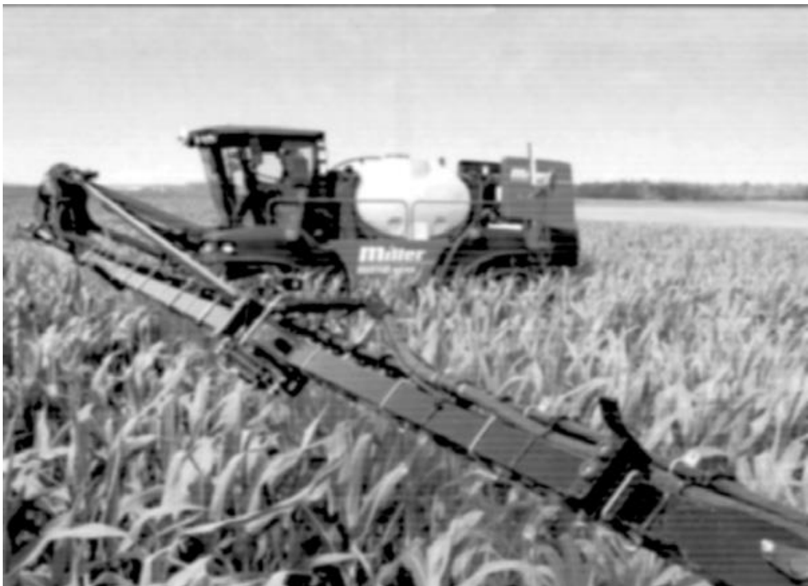
Рис. 47. Легка передня штанга обприскувача Miller Nitro 4240 швидко складатся на ходу перед розворотом уздовж лісосмуги і так же швидко розвертається
