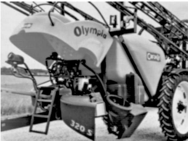
Рис. 50. Товстостінний (12 мм) пластиковий бак причіпного обприскувача Olympia 320 S
