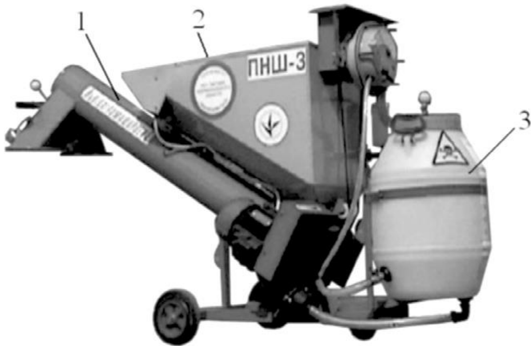
Рис. 22. Протруювач ПНШ-3 «Фермер»: 1 – шнек; 2 – бункер; 3 – бак
