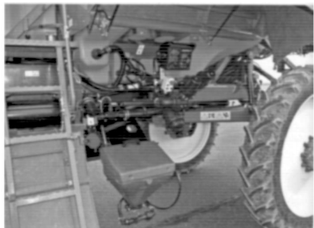
Рис. 50. Товстостінний (12 мм) пластиковий бак причіпного обприскувача Olympia 320 S
