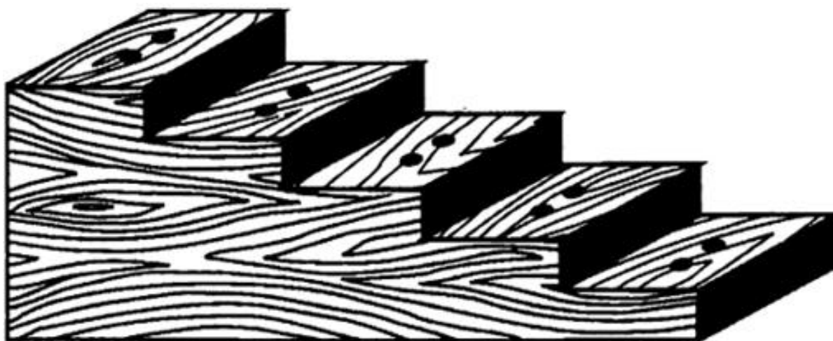
Рис. 5.23. Дерев'яний брусок у вигляді східців (боланка) для наколювання на ентомологічні голки етикеток та наклеєних на картонні пластини комах (за Голубом, 1980)
