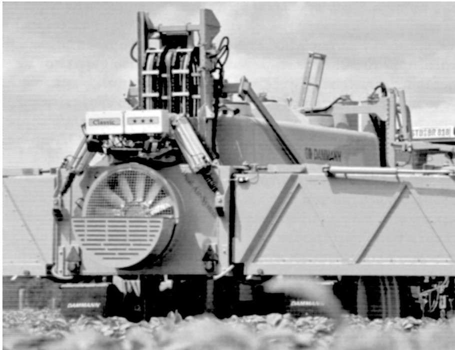
Рис.101. Зовнішній вигляд Dual-Air-системи і його вентилятора на штангах обприскувачів Dammann «Подвійний удар» за один прохід
