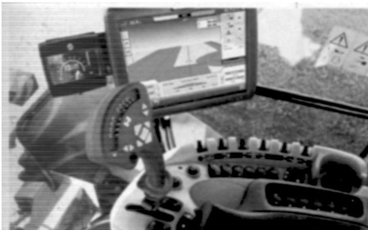
Рис. 105. Точне управління обприскувачем Hardi Saritor 5000 неможливе без космонавігаційної апаратури і оригінальної багатофункціональної рукоятки джойстика
