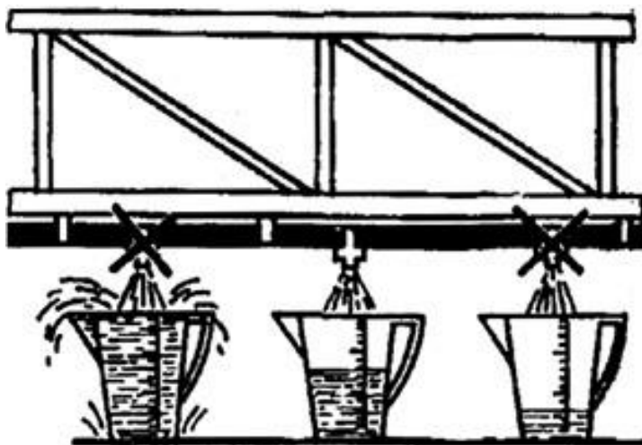
Рис. 78. Перевірка фактичної витрати рідини через розпилювачі
