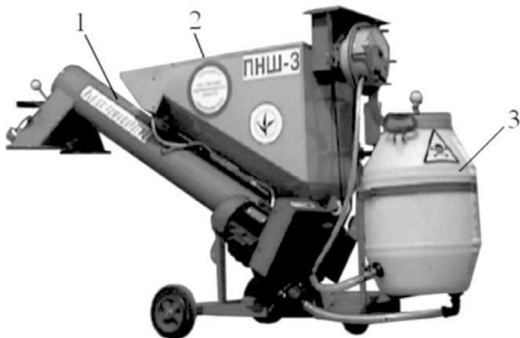
Рис. 69. Протруювач ПНШ-3 «Фермер»: 1 – шнек; 2 – бункер; 3 – бак
