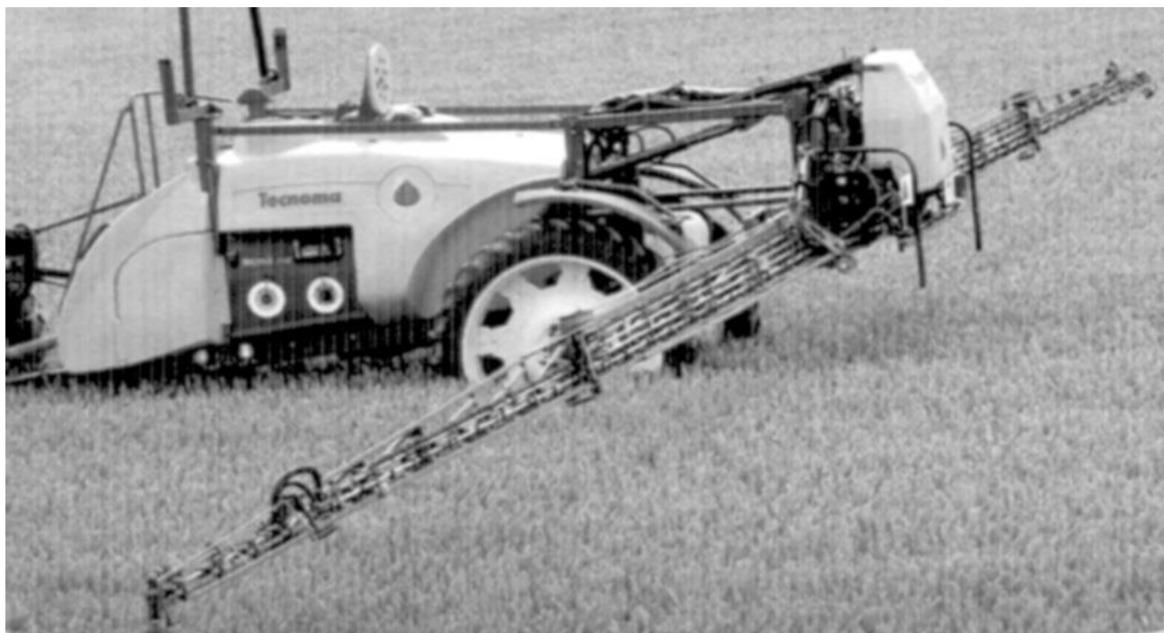
Рис. 96. Причіпний обприскувач TECNIS Об'єм бака робочої рідини 3100 л.+5 % Ширина захвату штанг 24, 28 м Необхідна потужність трактора 80–100 к. с.
