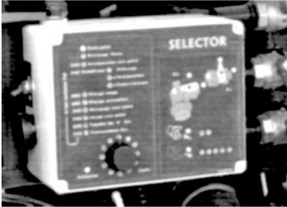
Рис. 98. Пульта діагностики і баки змішувачів причіпного обприскувача Olympia 320 S (ВОМ для насоса ГС) і самохідного Nimpheos 3240 від Caruelle-Nicolas
