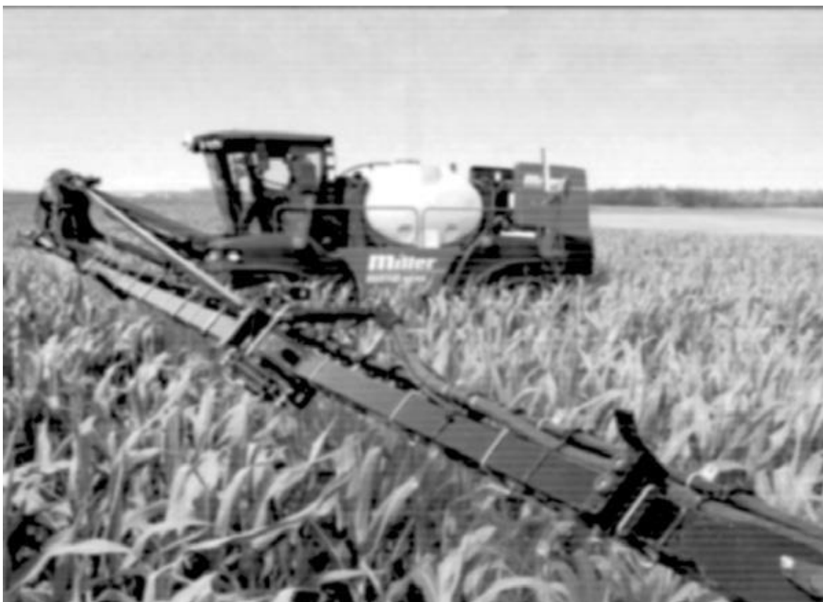
Рис. 106. Легка передня штанга обприскувача Miller Nitro 4240 швидко складається на ходу перед розворотом уздовж лісосмуги і так же швидко розвертається
