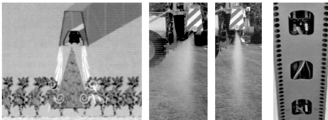
Рис. 102. Система подвійного повітряного потоку Dual-Air-System (D-A-S): а) D-A-S збільшує пробивну силу факелів розпилу, зменшує випаровування препарату і створює завихрення для обробки нижніх сторін листя; б) без підтримки повітря; в) з підтримкою повітря; г) канали випуску повітря перед і позаду форсунок
