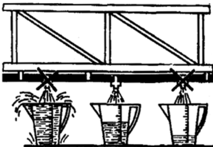
Рис. 78. Перевірка фактичної витрати рідини через розпилювачі
