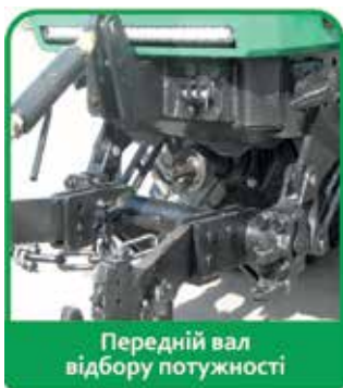
Передній навісний пристрій з захватами категорії 3
